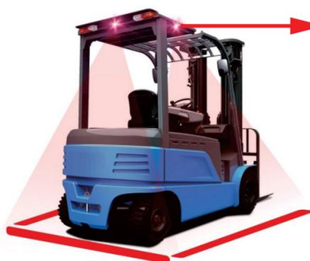
Оторвите двусторонний скотч и приклейте лазерный луч, который приклеен к середине заднего номерного знака. Подсоедините провод, включите противотуманную фару и отрегулируйте угол, под которым противотуманная фара направлена на землю, затяните винты
