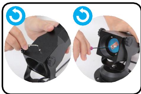
4. Ослабьте гексагональный винт снизу корпуса
