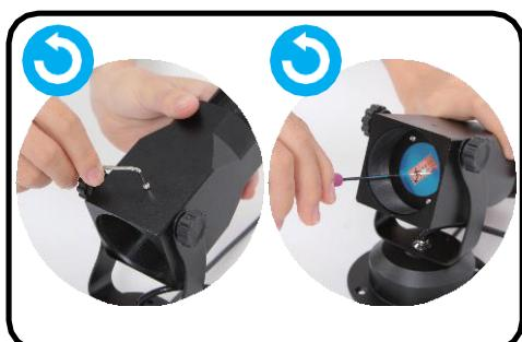
4. Ослабьте гексагональный винт снизу корпуса
