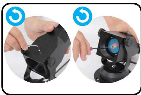
4. Ослабьте гексагональный винт снизу корпуса
