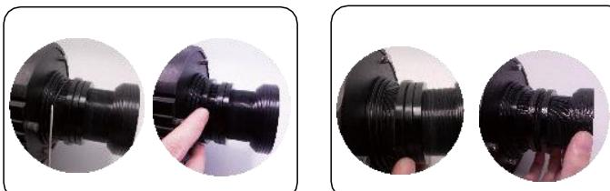
5. Внутренняя линза предназначена для изменения размера изображения. Внешняя линза - для фокусировки изображения.
