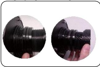
5. Внутренняя линза предназначена для изменения размера изображения. Внешняя линза - для фокусировки изображения.
